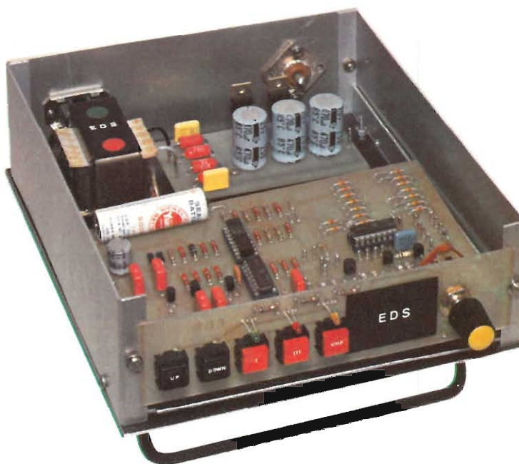
Vista interna del Tuning TV 20 canali a realizzazione ultimata.
